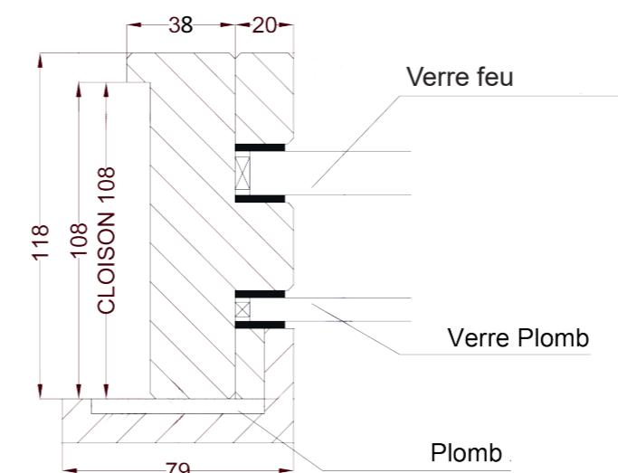
Châssis anti X EI 30 double feuillure
